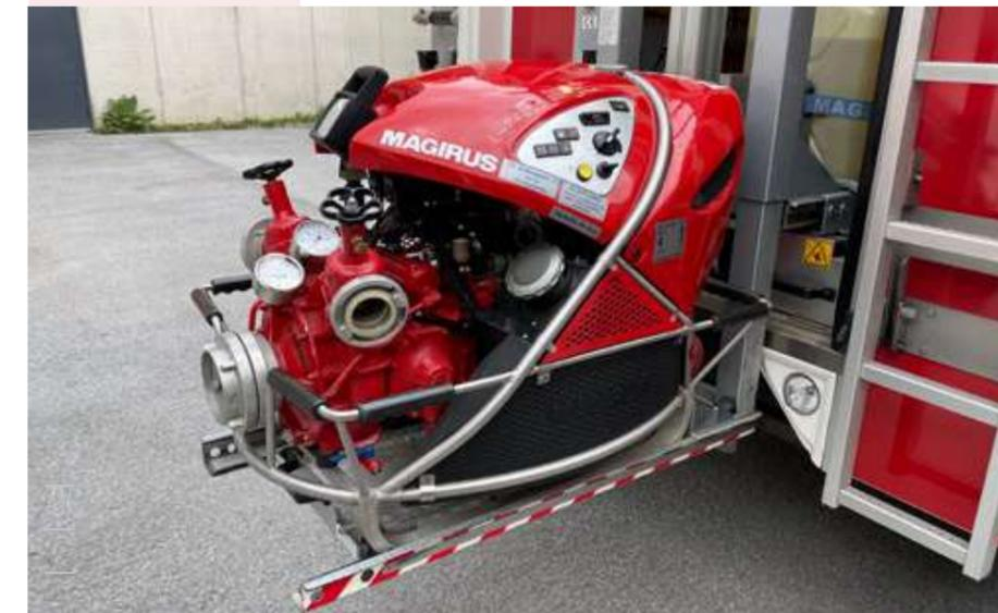
Die TS von Magirus wird am Löschfahrzeug mit „Hebelift“ verlastet.
