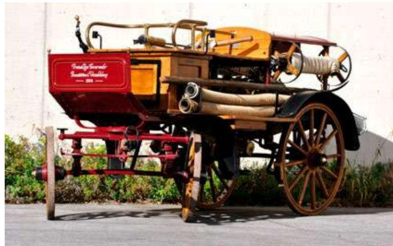
**Das erste Fahrzeug der Wehr ist eine Benzin-Motor-Spritze samt Pferdebespannung.**
